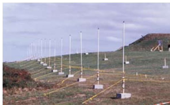
圖七d 由16根天線所組成的接收天線陣列
