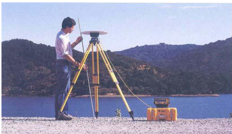
圖九 利用 GPS 衛星測量建立控制點
