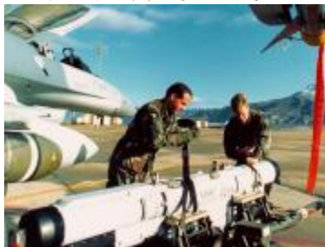
圖二 執行自衛式干擾之 ALQ-184 電戰策艙
