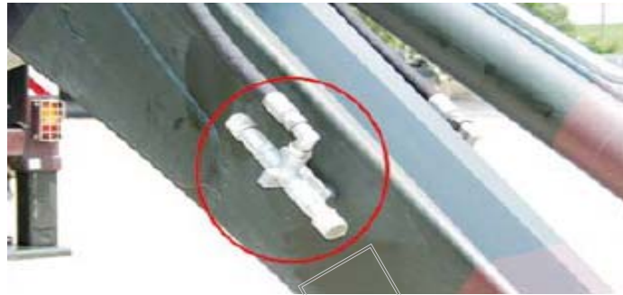
圖十五 奇庫洛華 880E 工兵車後挖斗液壓快速接頭
