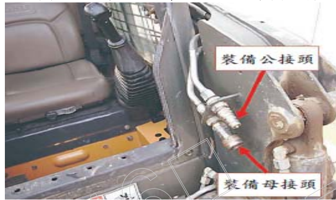
圖十七 凱獅 430 附屬工具液壓油管與接頭
