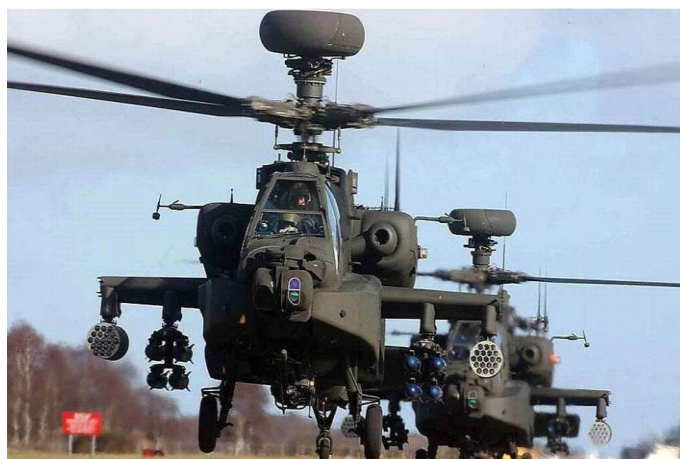
圖九 AH-64E 主旋翼上方裝置長弓毫米波雷達系統
