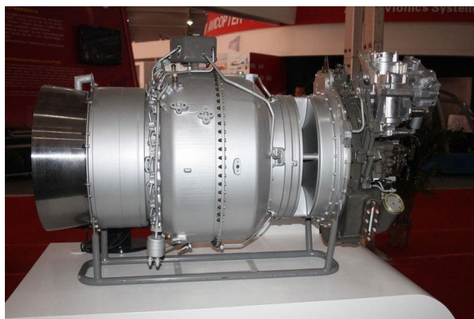
圖八 中航工業與法國聯合研製的渦軸-16 發動機
