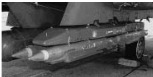
掛於F-15E機翼派龍下，由一具BRU-61A炸彈架攜帶的四枚小直徑炸彈。
