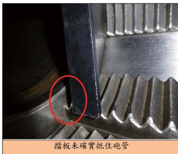
圖七 擋板未確實抵住砲管（資料來源：作者提供）
