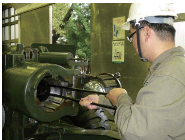
圖四 拉越式測膛樣板檢測作業
