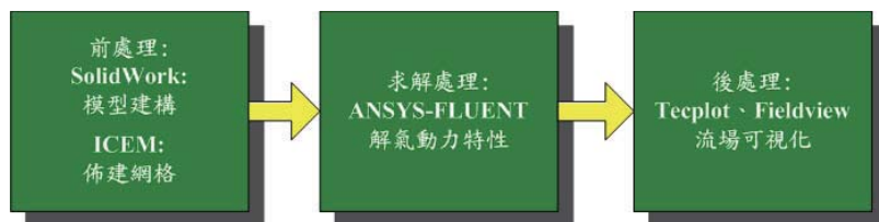
圖五 數值模擬CFD前中後處理流程
