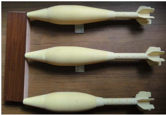
圖八 實驗彈體模型、角度板及夾具 (資料來源：作者提供)
