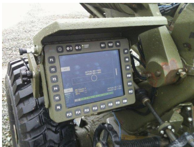
圖三 安裝於 L118 式 105 公厘輕榴砲左砲耳之新型「瞄準手顯示與控制單元」 (LDCU)
