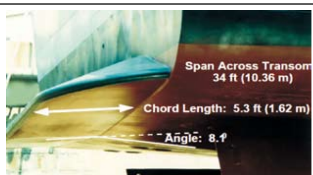
圖八 DD-968驅逐艦加裝的艦副翼
