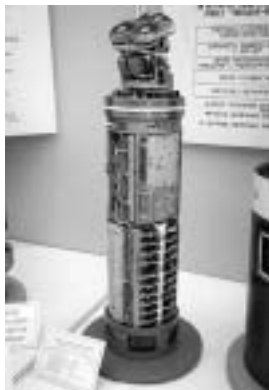
俄羅斯R-27飛彈 的半主動雷達歸 向導引尋標器。
