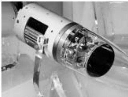
雲母飛彈尋標器的脈波都卜勒雷達，具有把干擾源當做目標進行攻擊的能力。
