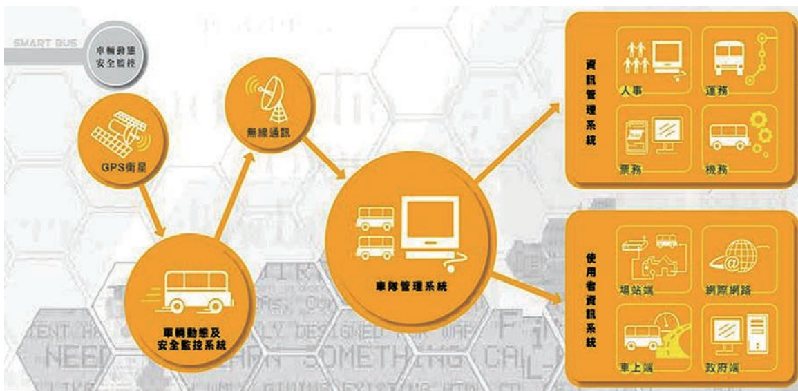
圖五 聰明巴士車隊管理運作流程 8
