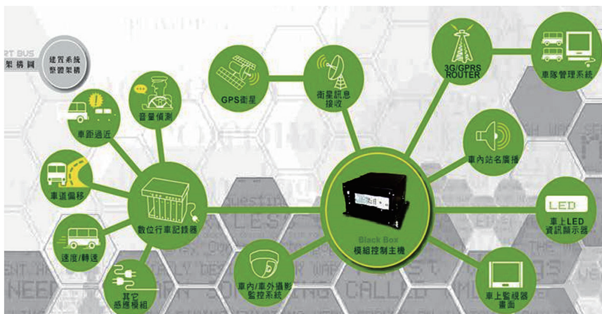
圖四 和欣客運公司車輛動態資訊系統架構 7
