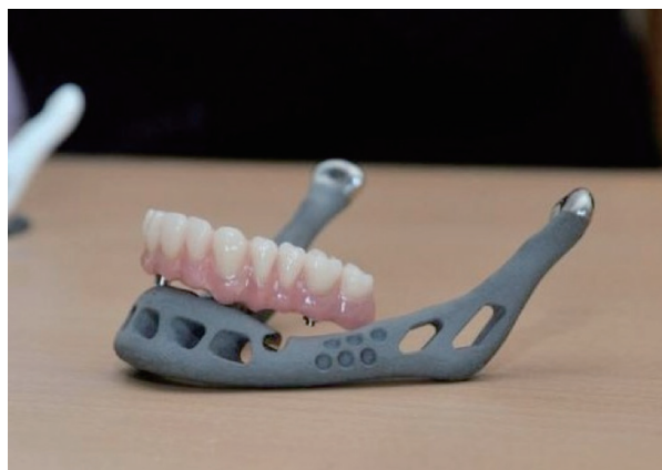
圖十 比利時LayerWise公司以鈦金屬粉3D列印出下巴骨 24
