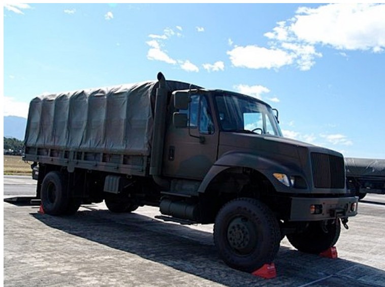
圖一 中型戰術輪車可載運大量人員及物資，且涉水深度達80公分 5
