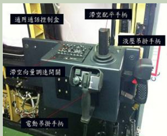
圖十一 EC-225吊掛滯空手柄及吊掛控制盒
