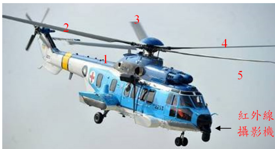
圖五 EC-225五片主旋翼葉片及紅外線攝影機 (中央社記者陳培煌攝於嘉義101年1月17日)
