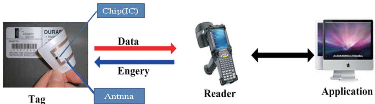
圖一 RFID系統基本元件組成圖(資料來源：作者繪製)
