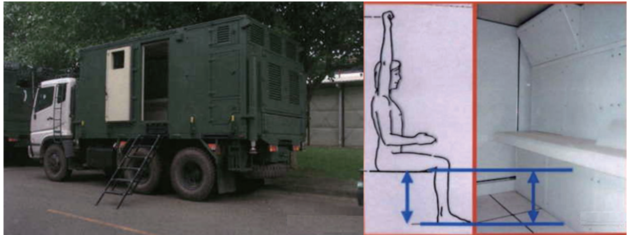
圖一 人體計測運用於機動雷達車內部設計 (作者繪製)
