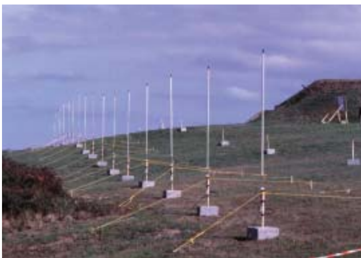
圖五 相位陣列方式排列雷達
