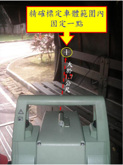
圖十三 操作手轉動測距經緯儀望遠鏡精確標定車體範圍內固定一點
