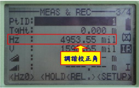
圖十四 看讀徠卡測距經緯儀顯示幕之「調諧校正角」並記錄之
