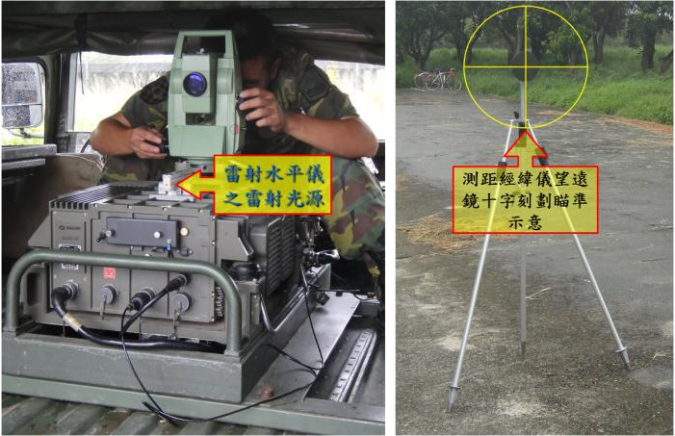
圖十二 操作手轉動測距經緯儀望遠鏡瞄準反射器標示板後裝定3200密位
