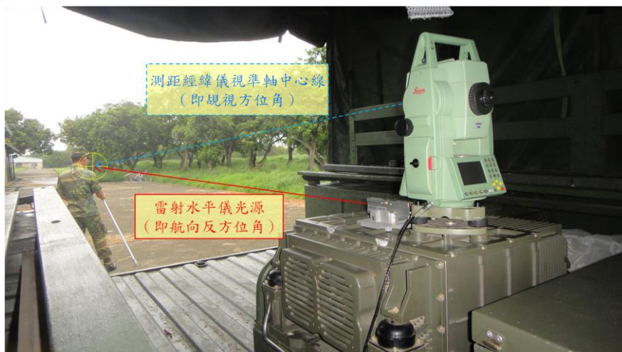
圖五 新式調諧校正-雷射法操作原理示意（二）
