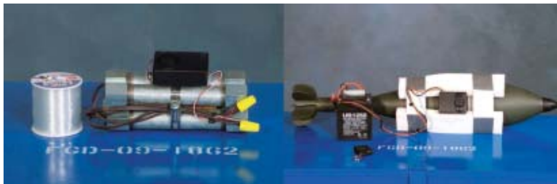
圖九 2種美軍於陸軍訓練支援中心作為人員訓練用的應急爆炸裝置，左圖是以繩子綁住裝有炸藥的管子製成的模擬彈，右圖則是在槍榴彈上加裝遙控引信的模擬彈
