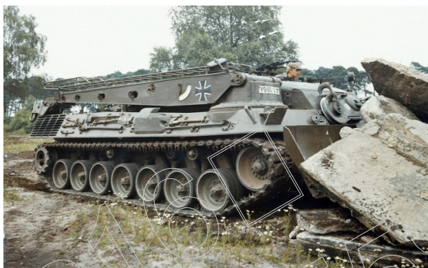
圖四 豹式戰鬥推土機正使用鏟刀作業
