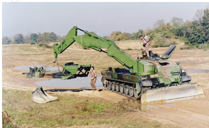
圖三 EPG 戰鬥推土機使用液壓吊臂資料
