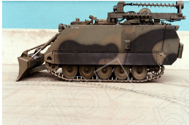
圖九 配有鏟刀和螺絲鑽的加拿大 M113SEV 戰鬥推土機
