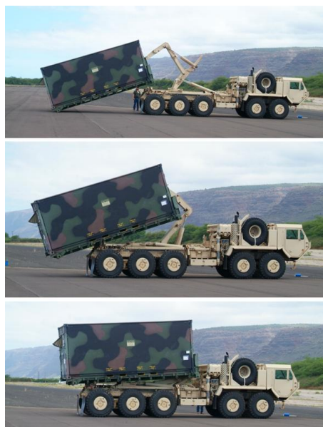
圖十二 泰德系統發射車更換彈箱過程
