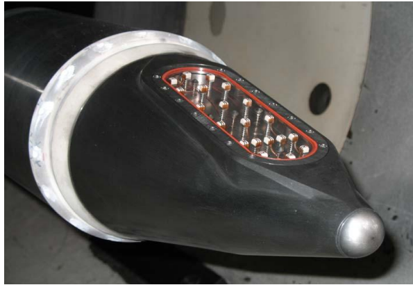
圖十四 泰德攔截彈體彈頭 IMU 參據輸入介面
