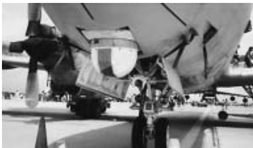
P-3C機鼻下方的前視紅外線搜尋裝置。
