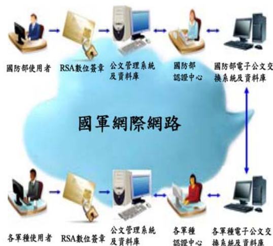
圖 2 電子公文系統線上簽核及公文交換流程圖
