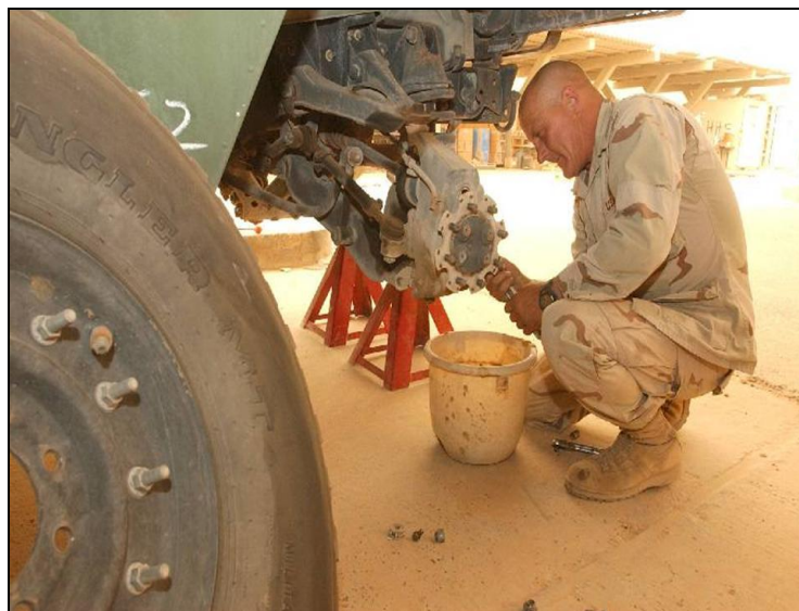
圖七 美軍 MEADS 系統機動保修小組針對飛彈發射車進行主動游修
