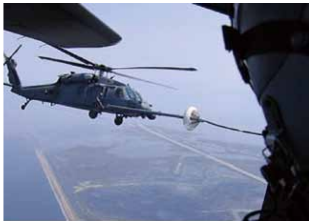
一架參與卡翠娜颶風救災任務的HH-60鋪鷹直升機，正由C-130進行空中加油。(照片來源：參考文獻13)
