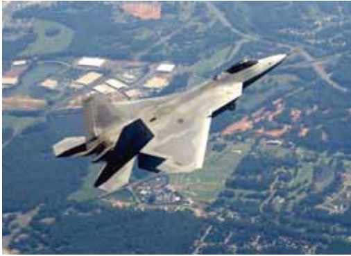
圖六 F-22A採用向量噴嘴及尾翼遮蔽法降低紅外信號
