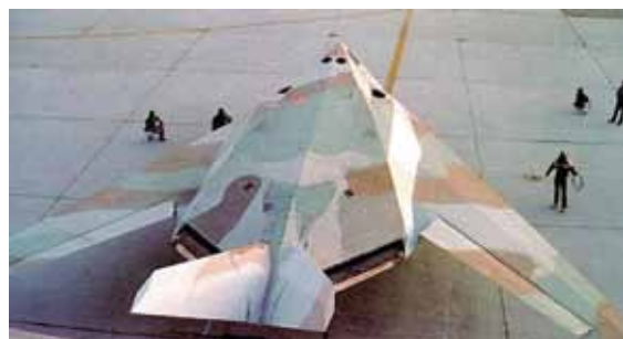
圖五 F-117A戰機採用尾管遮蔽技術減少紅外輻射信號
