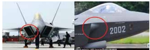
圖三 J-20戰機DSI進氣道與F-22戰機傳統進氣道設計對比圖
