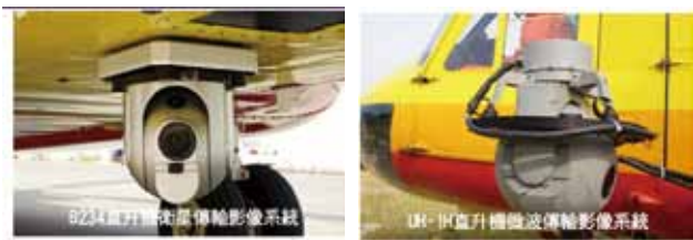
圖三 空勤總隊直升機衛星傳輸影像系統
