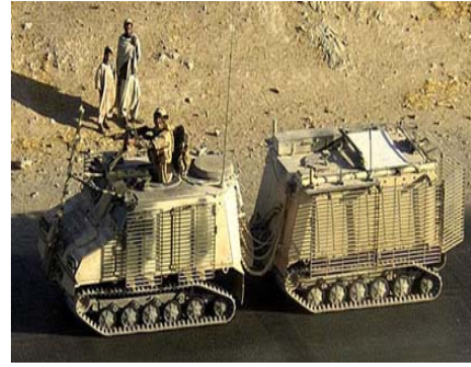
圖五 英軍在阿富汗戰場使用的防 RPG 格柵
