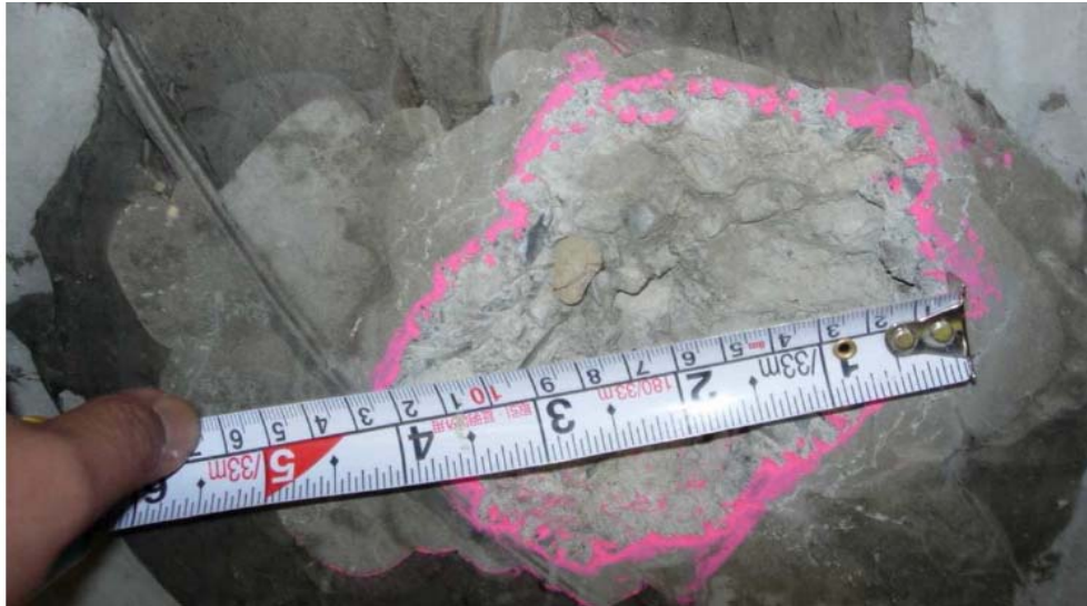
圖七 鋼筋混凝土結構於 30 克 C4 炸藥內部爆炸後-內部狀況
