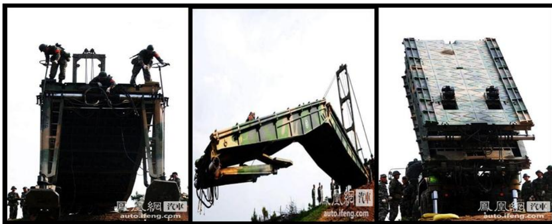
圖一 重型機械化橋車實施架橋作業
