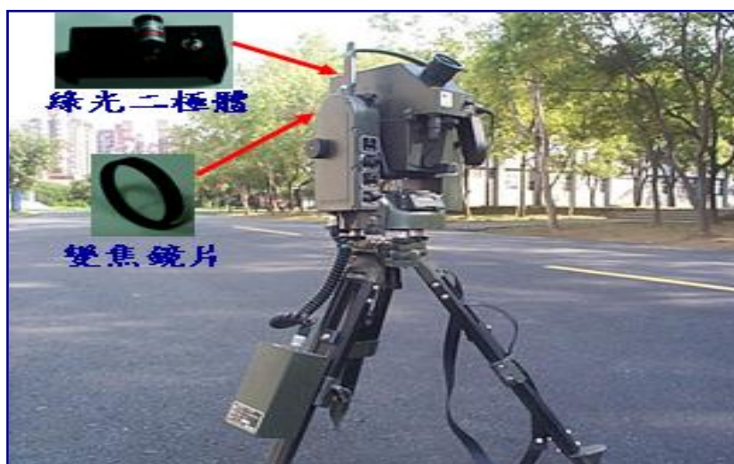
圖八 硬體(綠光二極體、變焦鏡片)加裝位置示意圖
