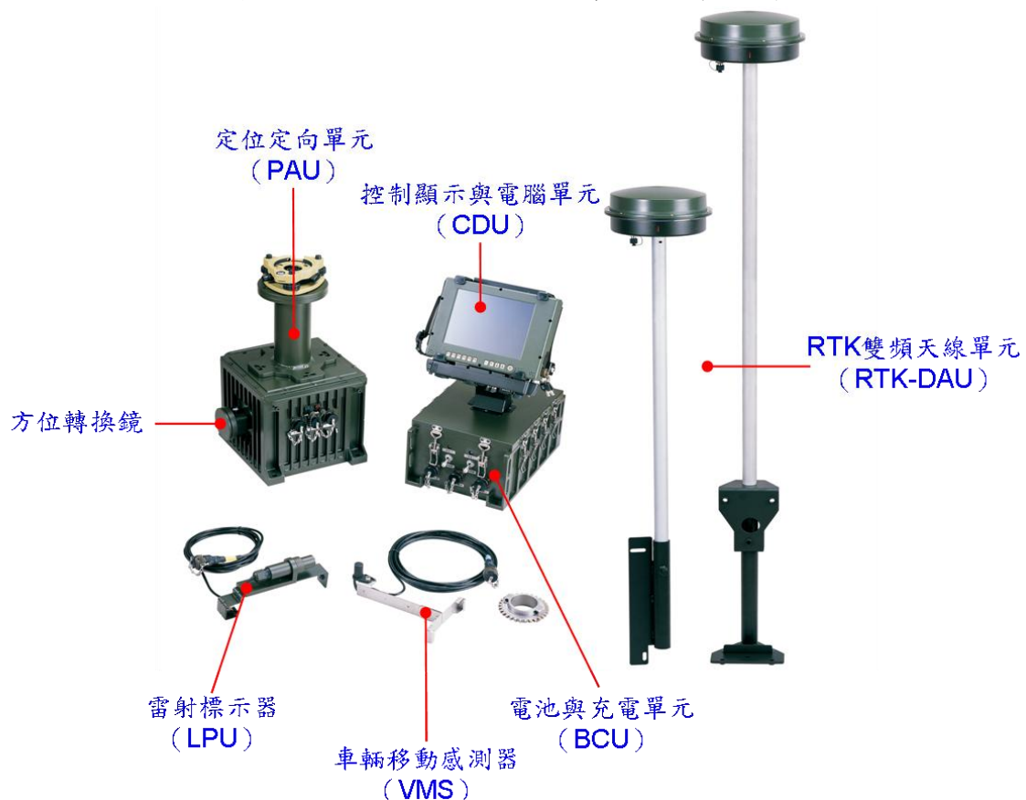
圖四 SPAN-7 定位定向系統各部名稱
