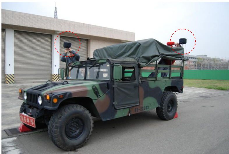
圖七 SPAN-7系統實施「無GPS輔助」測試前應先行遮蔽雙頻天線
