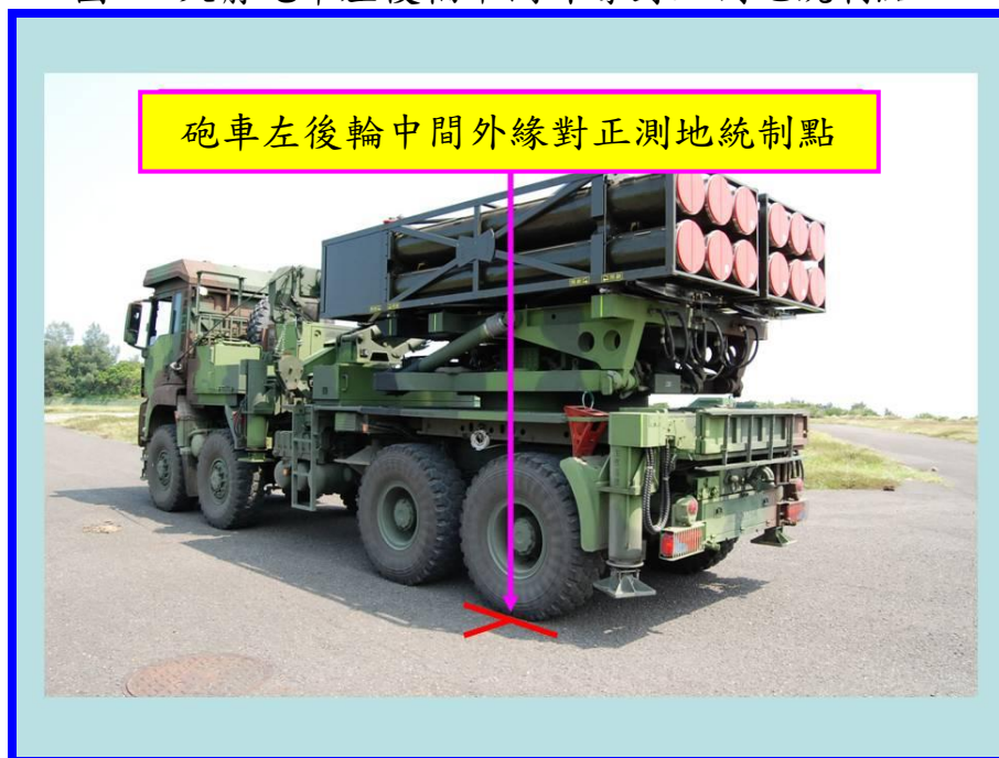
圖二 火箭砲車左後輪中間外緣對正測地統制點
