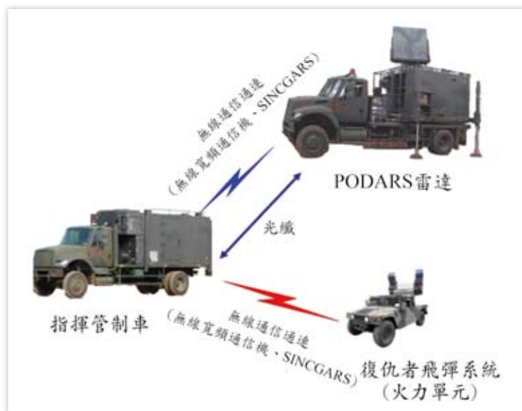
圖十五 蜂眼雷達系統組成
