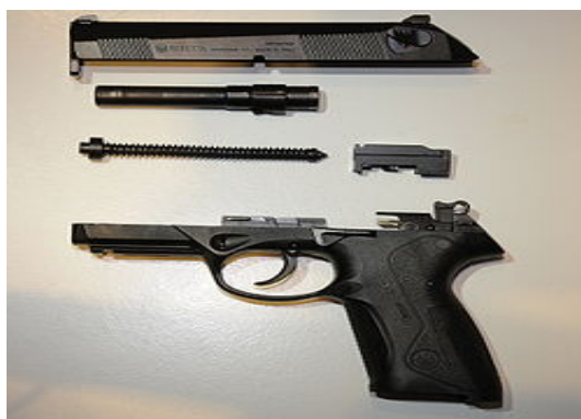
圖十三 貝瑞塔 Px4 Storm 可移除和通用的部件
