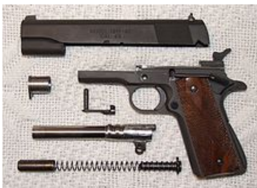
圖九 軍用型 M1911A1 的分解圖片
