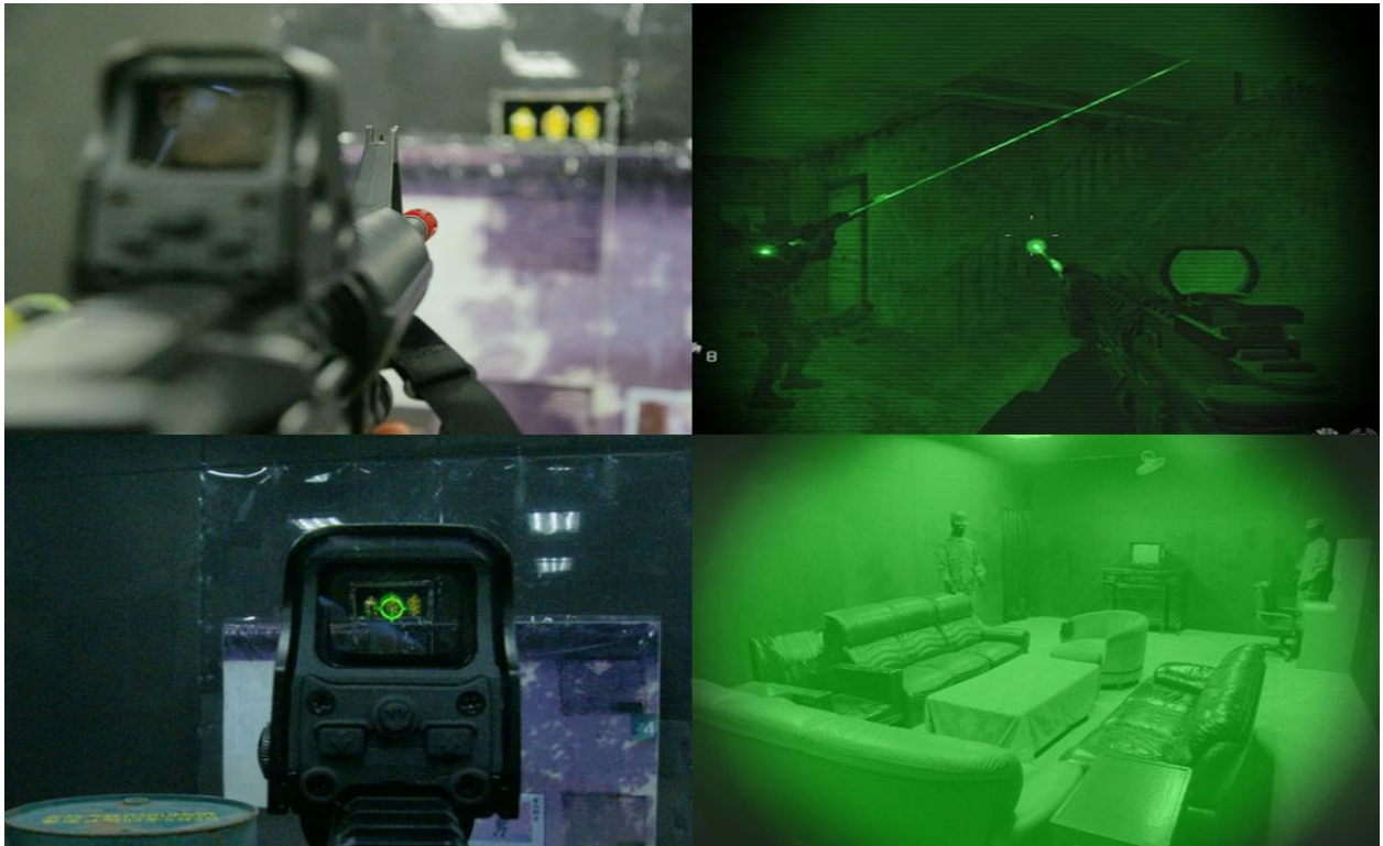
圖 4 模擬槍結合 Mode1551 式紅綠光快瞄鏡與雷射目標指示器。
