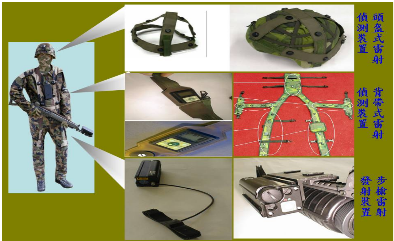
圖 5 單兵雷射接戰系統組成。
