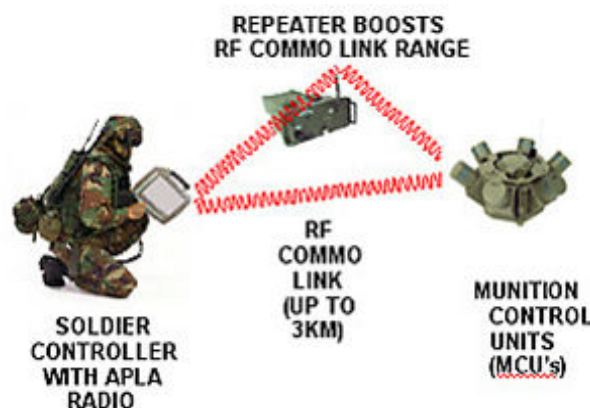
圖七 士兵透過無線電控制 XM-7「蜘蛛」智能地雷
