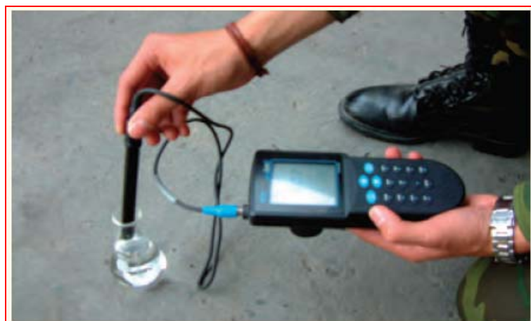
圖十九 水質導電度/TDS值檢測
