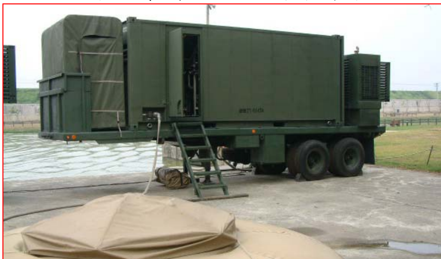
圖七 加拿大製ROWPU-3000型淨水裝備
