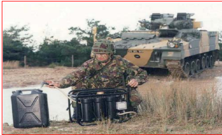
圖十三 英軍所使用的JWP8型淨水系統
