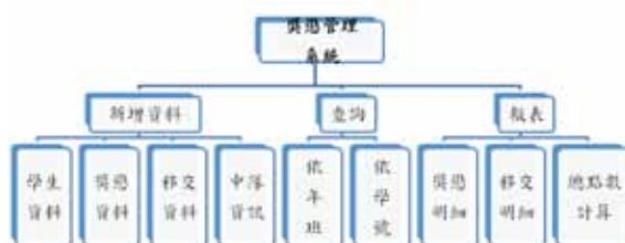
圖3.20 獎懲管理系統的系統架構圖
