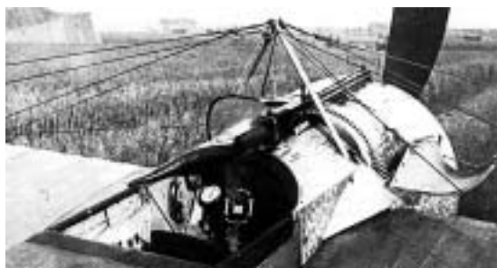
Fokker M.5k單翼機是第一架機關槍開火速率與螺旋槳旋轉位置同步的戰鬥機。
