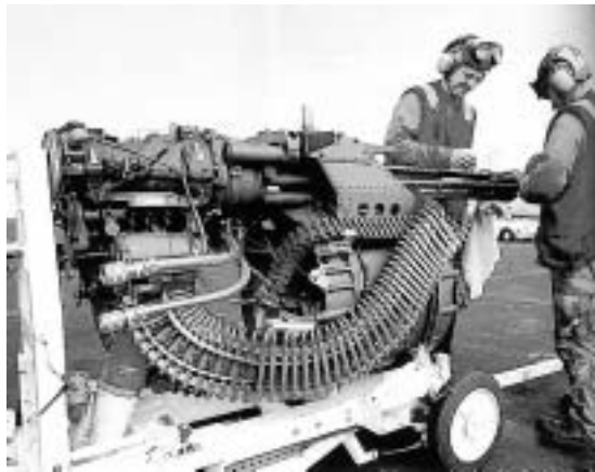
F-22戰機的M61火神機砲，具備六砲管和兩組無彈鏈給彈系統，一組送彈，另一組回收彈殼與未擊發彈。
