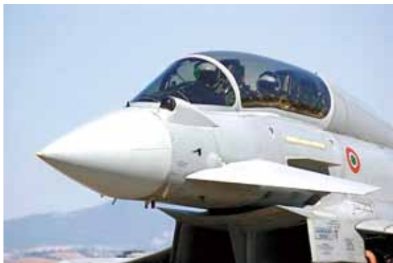
歐洲戰鬥機颱風號安裝於機鼻左側的「海盜」紅外線空用追蹤系統。(照片來源：參考文獻15)
