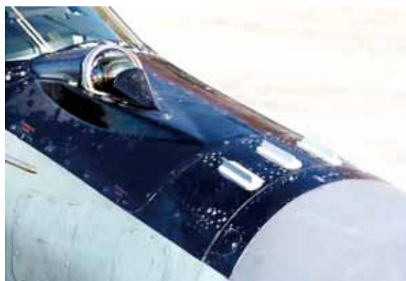
率先安裝OEPS-29現代化紅外線搜尋追蹤系統的MiG-29。(照片來源：參考文獻17)
