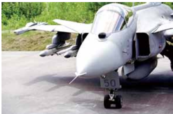
瑞典JAS-39戰機的IR-OTIS，安裝位置稍微偏左，以允許有限度的對地下視。(照片來源：參考文獻11)
