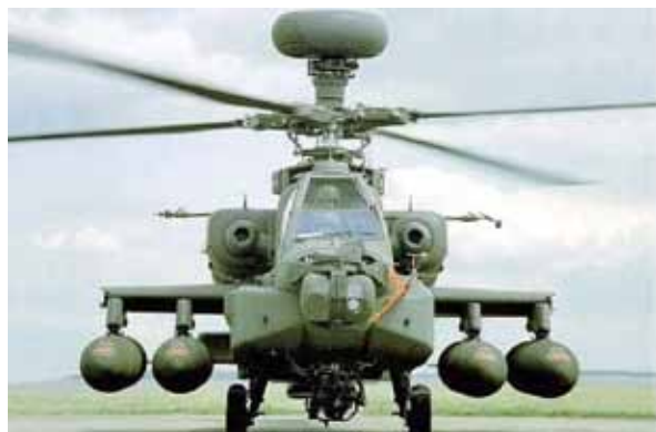
AH-64D阿帕契直升機旋翼上方圓餅狀的毫米波雷達。(照片來源：參考文獻18)
