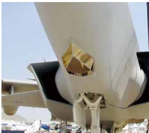
F-35主要任務為對地攻擊，故光電定標系統安裝於機腹上。(照片來源：參考文獻16)
