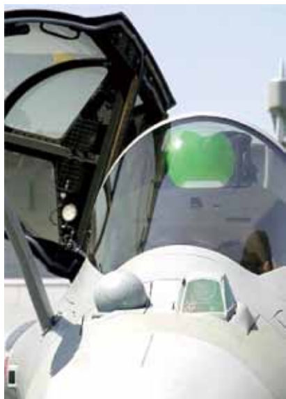
法國颶風戰機的前區光電感測器(右)及電視／紅外線感測器(左)。(照片來源：參考文獻9)
