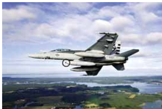
美國海軍以F/A-18F測試安裝於中線派龍副油箱前端的紅外線搜尋追蹤系統。(照片來源：參考文獻16)
