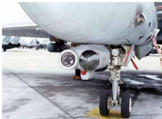
F-14D雄貓式戰機的AN/AAS-42紅外線搜尋追蹤系統，右邊是感測頭，左邊是光學放大辨識感測器。(照片來源：參考文獻13)
