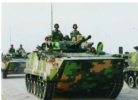
圖五 ZBD04 式車體前端採用楔形設計
