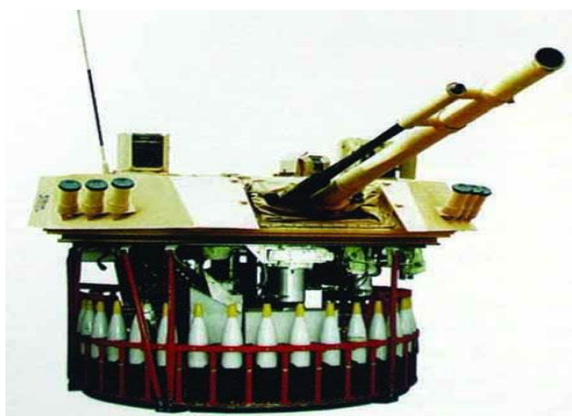
圖七 ZBD04 式的雙人砲塔示意圖
