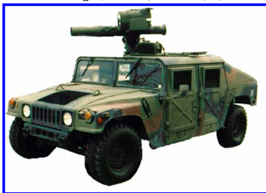
圖一：「ITAS」系統組裝於拖式飛彈悍馬車
