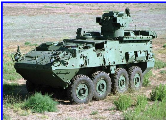
圖二：加拿大整合ITAS系統之LAV III裝甲運兵車
