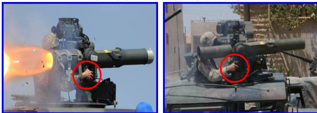
圖九：現有拖式飛彈與ITAS系統射擊操控方式對照圖
