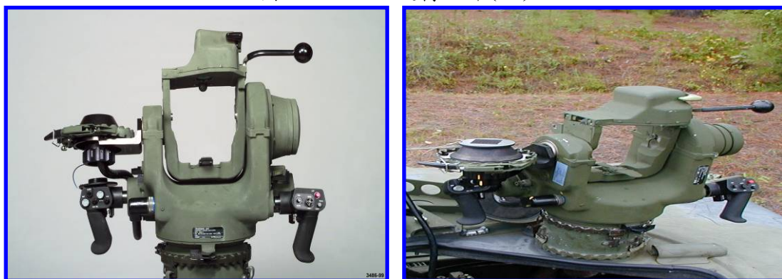
圖五：XM100 旋轉組件(TU)
