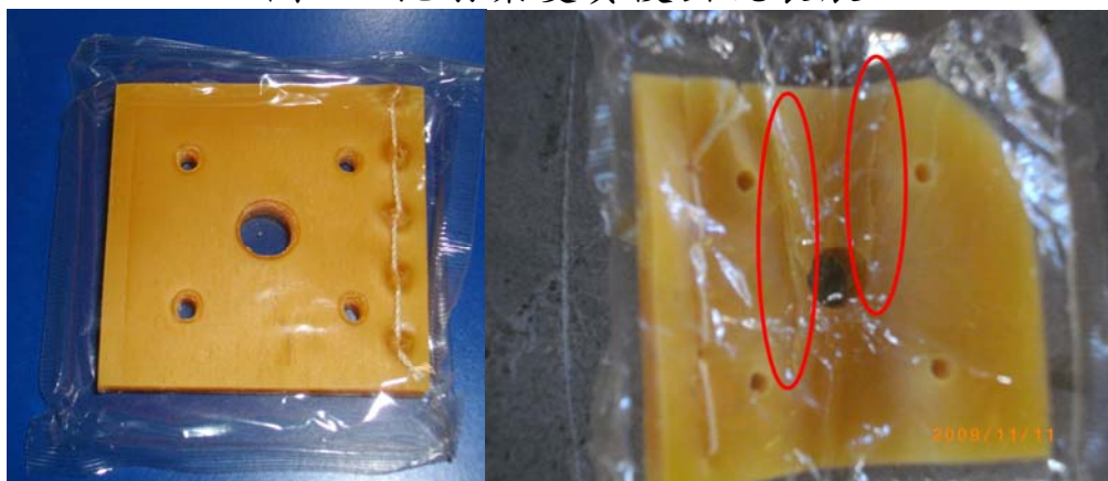
圖 2：拋射藥變質後出現裂痕
