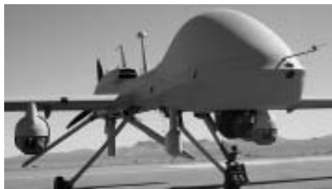
美國陸軍MQ-1C灰鷲正飛試中的三控光電偵察裝備
