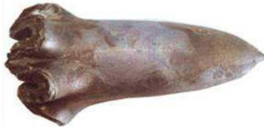
圖5：藥型罩經擠壓變形後形成的彈體，有良好氣動穩定外形
