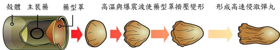
圖5：藥型罩經擠壓變形後形成的彈體，有良好氣動穩定外形
