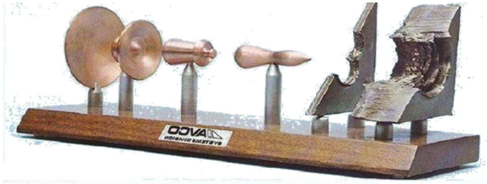
圖4：爆炸成形彈形成過程示意圖
