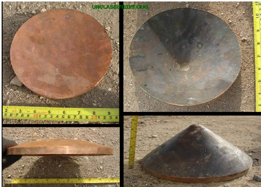
圖7：不同錐角角度的圓錐形藥型罩
