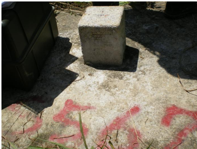
圖二 頂山（編號 S567）II 等衛星控制點（由編號 567 之 III 等三角點升級）
