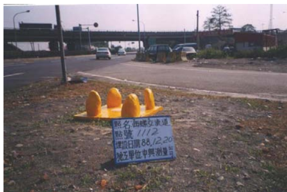
圖三 西螺交流道（編號 1112）I 等一級衛星水準點
