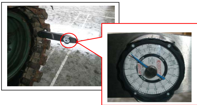
圖十七 終端連接器械型鐵使用扭力扳手實施鎖緊 資料來源：作者自攝
