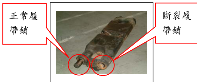
圖十四 履帶銷斷裂
