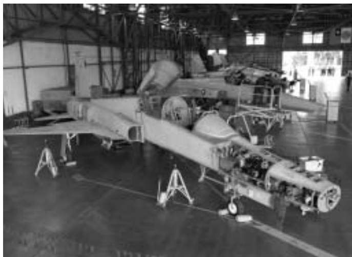
機體除噴漆與鏽蝕處理作業
